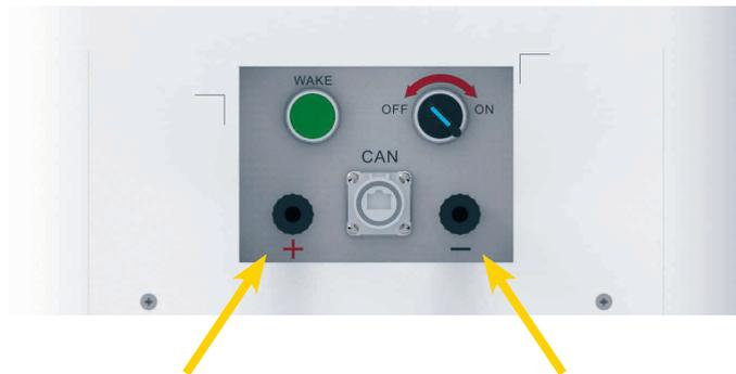
3- Conectar el cable con los conectores RJ45 a los respectivos puertos CAN de la batería y el inversor.
