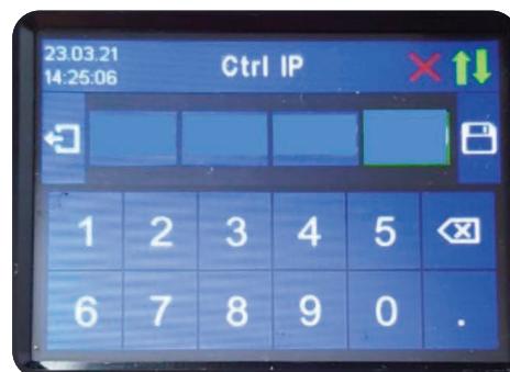
Introducir dirección IP del inversor SUNGROW
