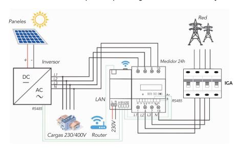
Las siguientes tablas muestran las conexiones eléctricas que hay que realizar en cada uno de los módulos:
